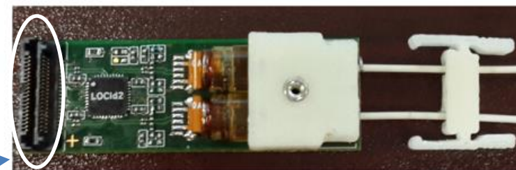
另一个定制化SFP类型的光模块（MTx）实物图
