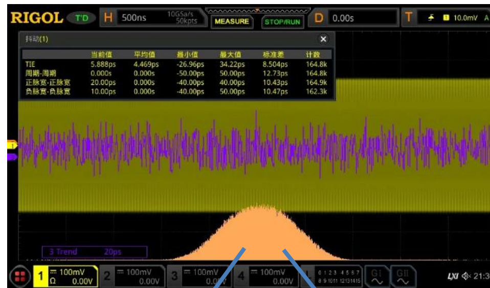
示波器以TIE分析方式展示某数字信号的jitter
