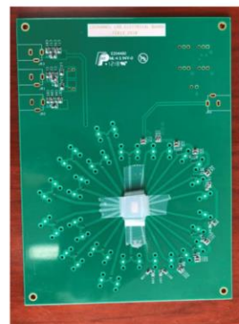
12通道接收芯片电测试板
